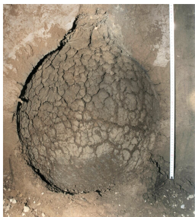
图1 在粉质黏土中爆炸形成的腔体壁面
